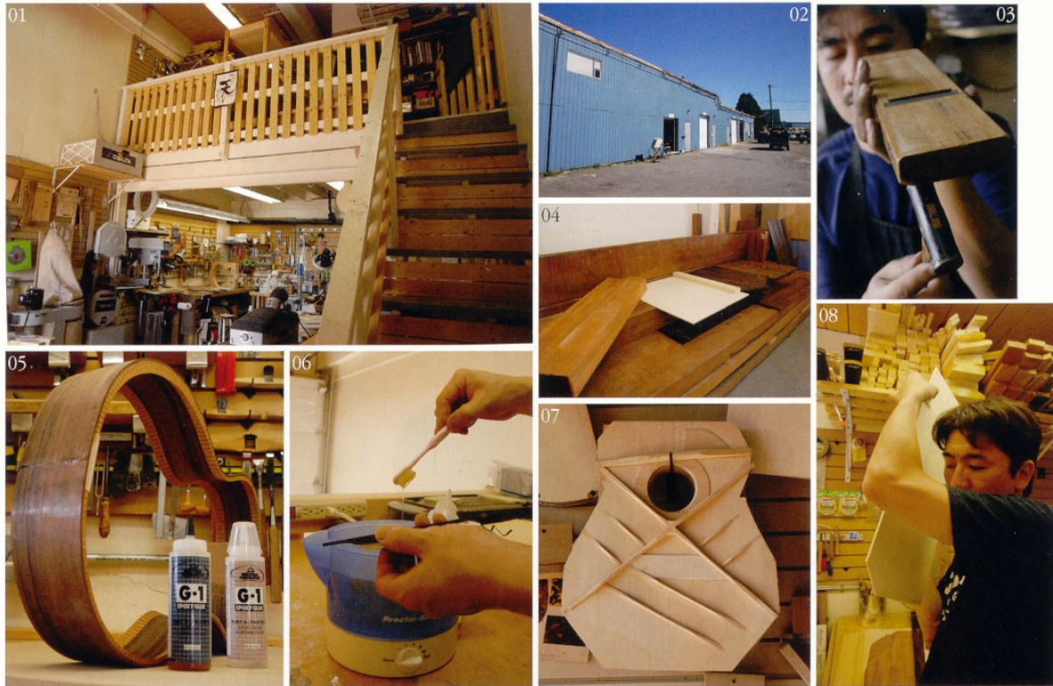
1.工具が整然と壁にかけられた工房内。2.工房外観。3.日本製のカナナを調整する。4.“日本では入手が難しい良い材を使ってギターを作りたい”というのが祐介がカナダに移住した動機のひとつだった。手前はレア材として知られるキューバン・マホガニーで、下の巨大なブロックはホンジュラス・マホガニー。ワシントン条約により取引が規制されているブラジリアン・ローズウッドを用いたギターも、もちろん法的にクリアな状態にして出荷している。5.製作中のサイドはマダガスカル(外側)／インディアン(内側)の各ローズウッドをエポキシ・ボンドで貼り合わせたレイヤード・スタイル。アームレストのベースとなる部分は別材のブロックを貼るのではなく、ホンジュラス・マホガニーのライニングを幅広にすることで製作する。6.ニカワの粘りを確認する。部位に応じてエポキシ・ボンドやホワイト・ボンドも併用。7.プレッシングはオーソドックスなスキャロップドX。トップ材は最も厚いところ(ブリッジ周辺)で約2.8ミリ、最も薄いところ(外周)で約2.0ミリと緻密に厚さを調整されている。8.アディロンダック・スプルースをタッピングする。
